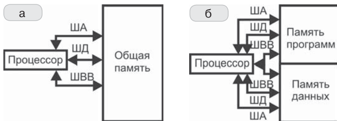
Рис. 7.59 ❖ Две архитектуры вычислительных систем: а) фоннеймановская архитектура; б) гарвардская архитектура
